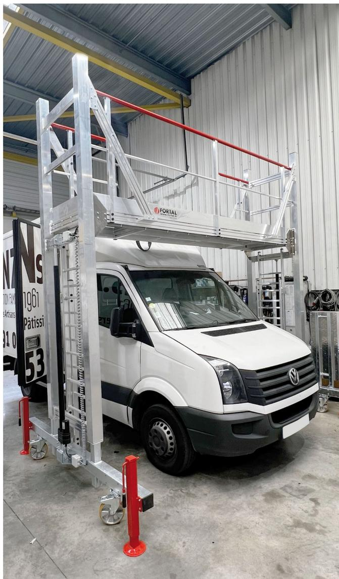
Mobile Plattform für den Zugang zu Kühleinheiten auf dem Dach von Nutzfahrzeugen für Wartungsarbeiten. Hauptstruktur aus Aluminiumprofilen. Rahmen aus verzinktem Stahl. Die gesamte Einheit ist mithilfe von Elektrozyindern von 2000 bis 3200 mm höhenverstellbar.
