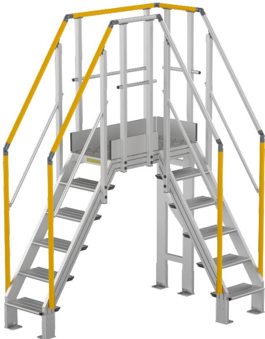
Überstiegsbrücken für das sichere Überqueren von Förderbändern ohne Produktionsstopp. Aus Aluminium gefertigt, mit rutschfesten Treppen und Plattformen sowie Geländern, bieten sie Sicherheit und Bedienkomfort. Speziell auf die Anforderungen unseres Kunden ausgelegt, passen sie sich optimal an den verfügbaren Raum und die Zugangsbeschränkungen an.
